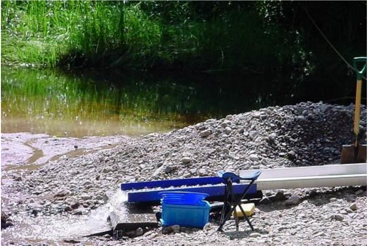
Un sluice utilisé pour traiter un plus gros volume de sédiments
