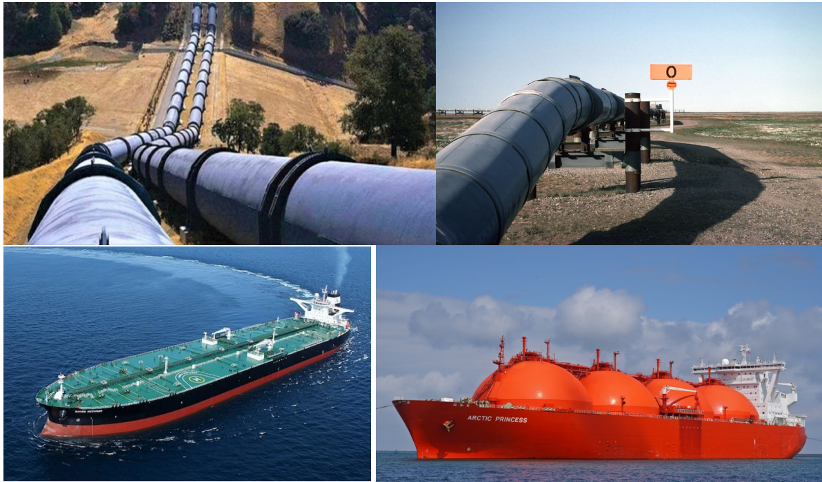
PHOTO 4 : DE GAUCHE À DROITE, UN GAZODUC, UN OLÉODUC, UN PÉTROLIER ET UN MÉTHANIER
